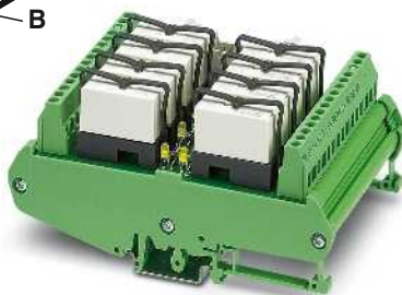
Модуль вывода с 8 миниатюрными реле, 1 переключающий контакт
